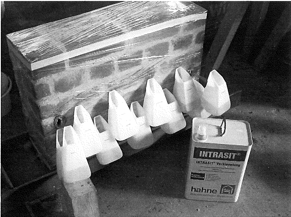
Bild 5: Füllstand nach 2 Tagen Beaufschlagung - Beendigung Applikation
