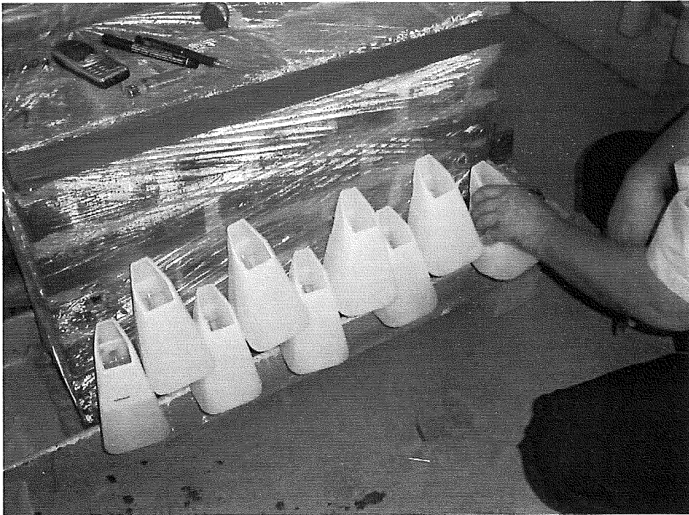
Bild 3: Einsetzen der Tröpfelbehälter und Probefüllung
